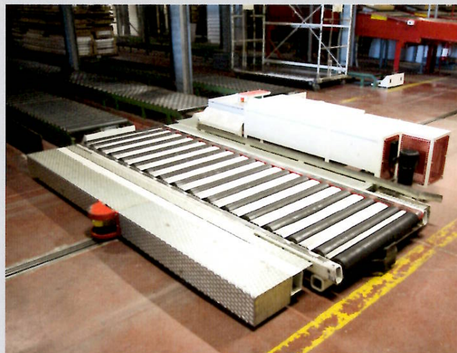
Carrello traslatore motorizzato con rulliera trasporto cateste senza uomo a bordo azionata da telecomando radiofrequenza
