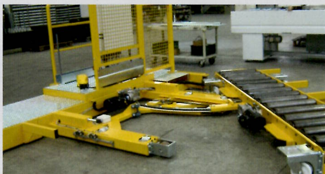
Carrello traslatore motorizzato con rulliera motorizzata rotante 0-45° per mocimentazione cataste pannelli
